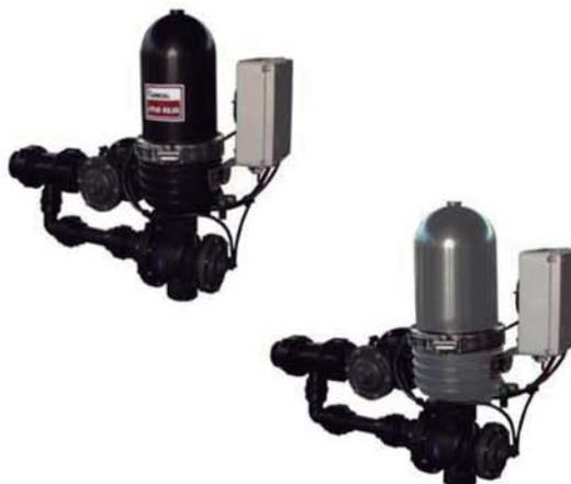
las anillas, se desencadena el proceso de limpieza, el cual activa las válvulas de contralavado, cambiándola de posición e invirtiendo el sentido del flujo en el interior del filtro.
