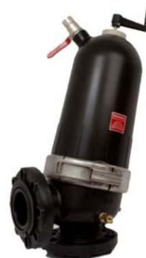
Progresivamente se va creando una diferencia de presión entre la entrada y la salida de la malla. Cuando esta diferencia de presión alcanza un valor determinado (como máximo 0,8 bar), se debe proceder a realizar el proceso de lavado.
