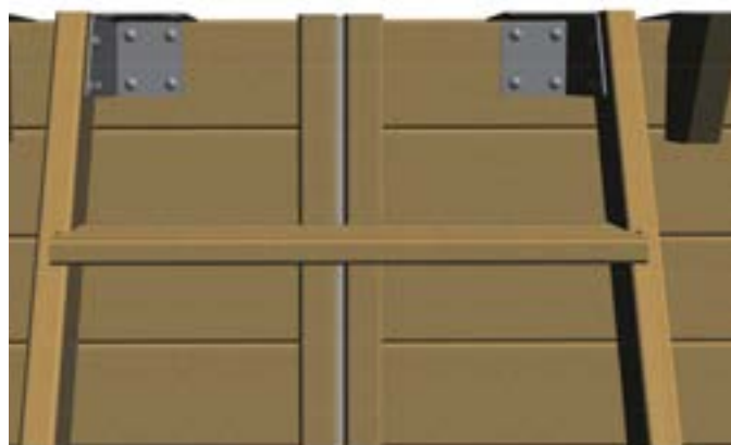
Figure 18 – Fixation de l'escalier extérieur sur le bassin
