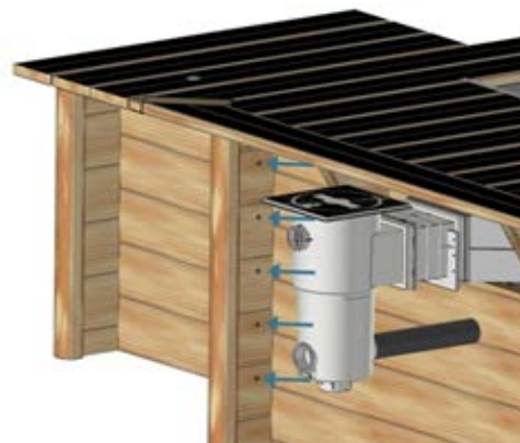
Figure 64 – Fixation du coffre sur le bassin
