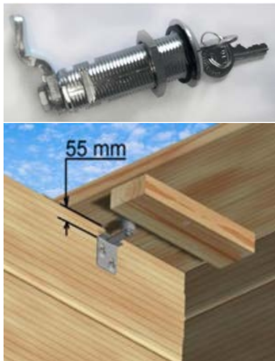
Figure 68 – Montage de la serrure
