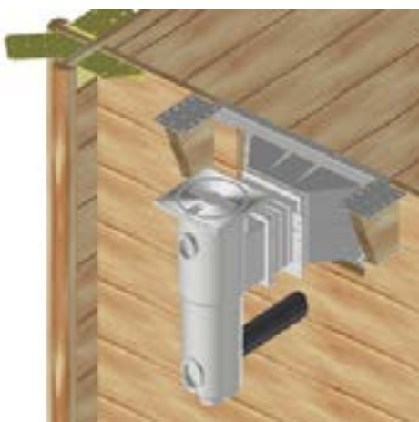
Figure 25 – Montage de l'équerre de skimmer
