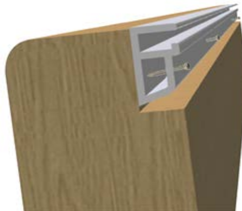
Figure 31 – Pose du rail d'accrochage
