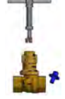
6 Extraer la llave y introducir el tapón de protección. La válvula permanecerá bloqueada (en 10% apertura). / Remove the key and insert the plastic protection cap. The valve will remain locked (at 10% opening).
