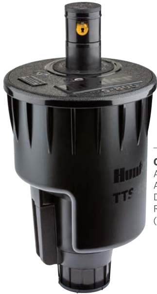
GT-835 Altura emergente: 8 cm Altura total: 30 cm Diámetro de la tapa: 18 cm Rosca hembra de entrada: 1½" (40 mm) Acme
