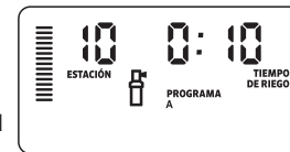
Ciclo de la estación 10 en funcionamiento
